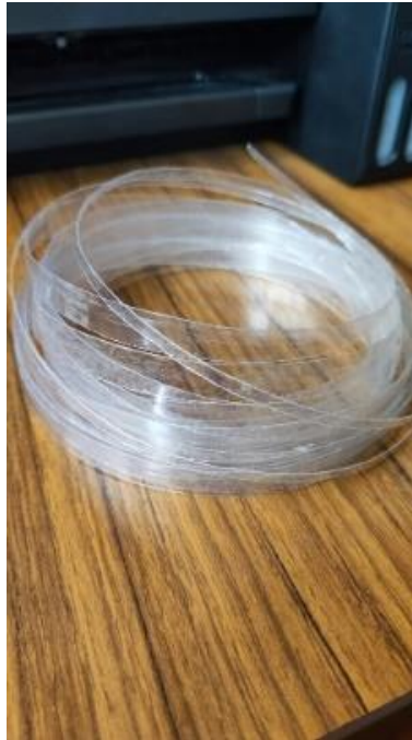
Fig. 10. Cinta de plástico materia prima para el Polyformer. Foto elaboración propia.
